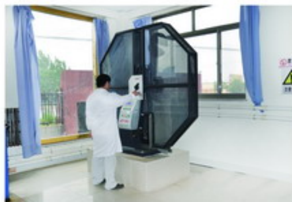
MTS ZBC2752-2 冲击试验机 MTS ZBC2752-2 Impact Test Machine
