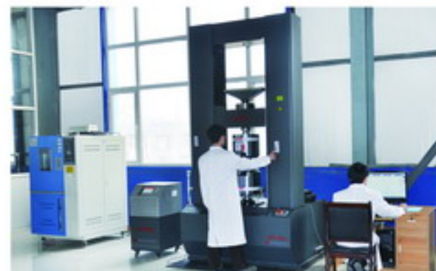
MTS 600kN 微机控制电子万能试验机 MTS 600kN Electromechanical Universal Testing Machine
