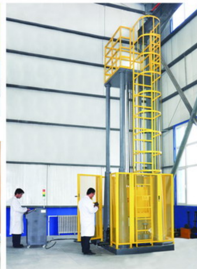
zc2504落锤撕裂试验机 zc2504 DWT Machine
